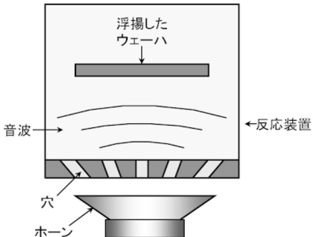
音波がウェーハを持ち上げて装置底面との接触を防止
